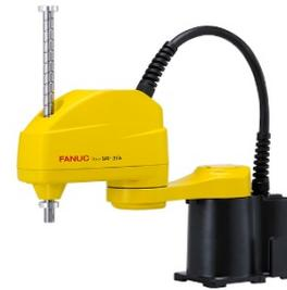
O novo robô SCARA da FANUC dispõe de uma operação precisa e de alta velocidade para processos de recolha e colocação, montagem, teste/inspeção e embalagem numa vasta gama de indústrias incluindo eletrónica de consumo, componentes automóveis, plásticos, automação laboratorial, eletrodomésticos e fabrico de dispositivos médicos. Um design compacto, ultraleve e limpo proporciona significativas poupanças de espaço.
